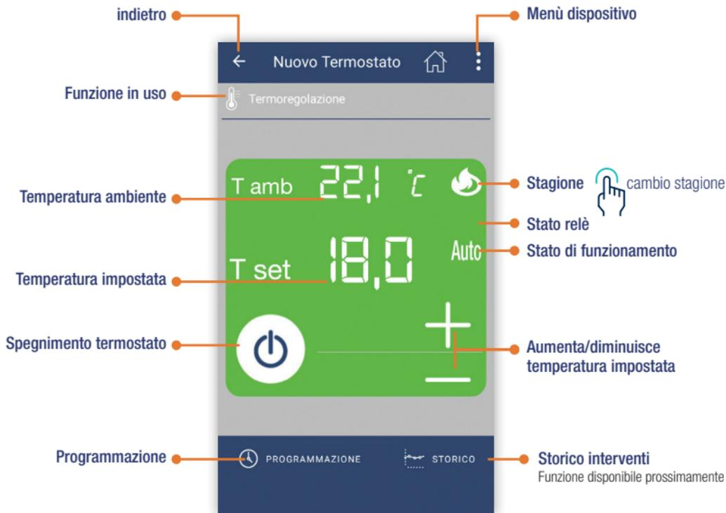
Premendo il tasto spegnimento il termostato andrà in modalità **OFF permanente**.
