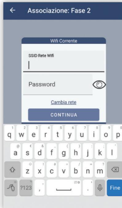
Effettuata la scelta della rete Wi-Fi a cui ci si vuole collegare, inserire la password di accesso alla rete, questa operazione è per condividere queste impostazioni con il termostato.
