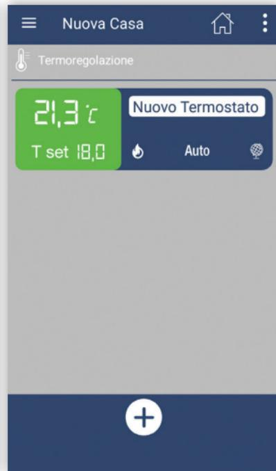
Schermata principale dove è possibile visualizzare le informazioni generali e riassuntive degli apparati installati in una casa. Da questa schermata è possibile accedere a: Menù generale, Menù casa, funzioni de termostato e stati di funzionamento dei termostati abbinati.
